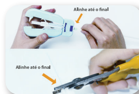
3- Desencape a camada de revestimento
