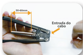
1- Desencape a camada externa do cabo
